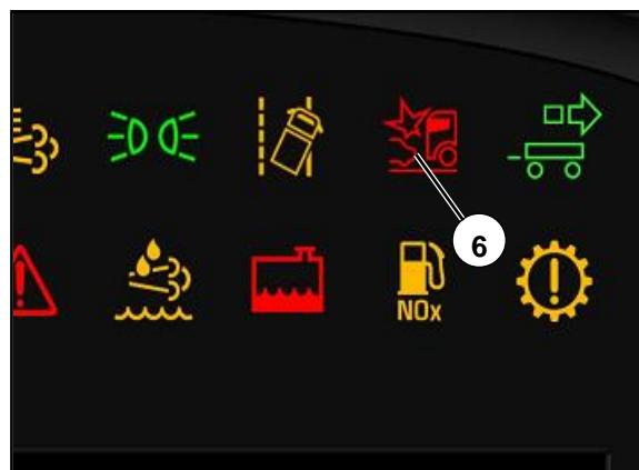
当仪表上有图标⑥成黄色常亮显示（驾驶员未主动关闭系统）时，为系统发生故障，应立即联系中国重汽服务站处理。
