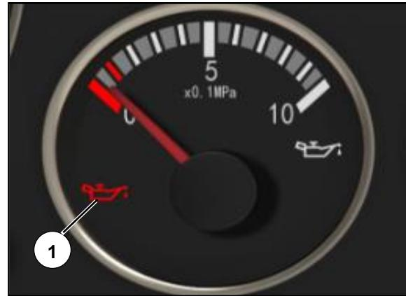
发动机起动时，驾驶员显示屏不能出现下列任何一种显示：“机油压力报警”信息。
