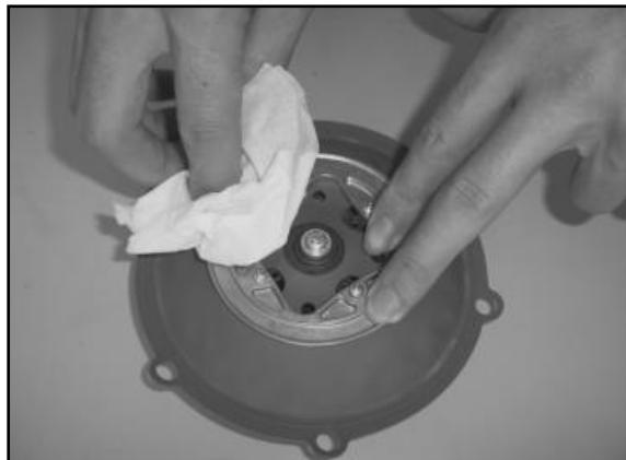
**清洗膜片:** 用干净的棉纱清除膜片上尘土或油污，若膜片上油污严重时，可用棉纱沾少量的无腐蚀性清洁剂进行擦拭。清洗时，注意检查膜片是否开裂、是否有磨损的部位，有此类现象时，应更换膜片。
